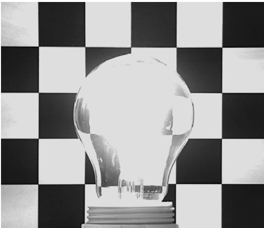
Bild 2: Bei linearer Belichtung ist die Glühbirne überbelichtet.
