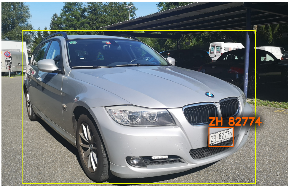
Abbildung 1: Automatisch detektiertes Nummernschild an einem Fahrzeug bei Stettbacher Signal Processing AG.
